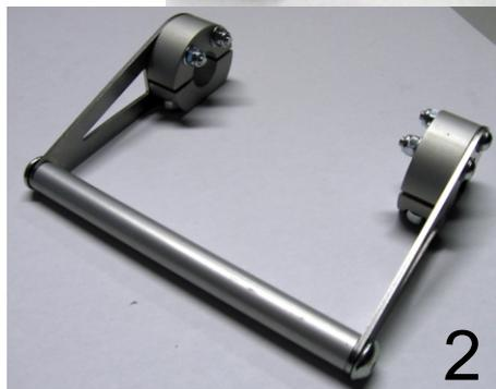
Schrauben Sie das Mittelrohr mit den Schrauben M8x10 an die beiden Seitenhalter. (Siehe Bild 2)
