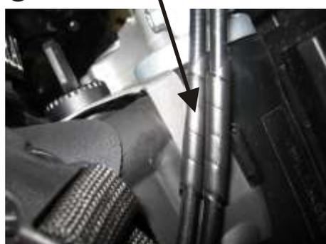
4. Spiralschlauch (C) halbieren und die beiden Hälften wie in Bild 3 um die beiden Gaszüge wickeln! Unbedingt die korrekte Anordnung der Gaszüge bei Volleinschlag prüfen! Die Gaszüge müssen auch bei Volleinschlag freigängig sein!
